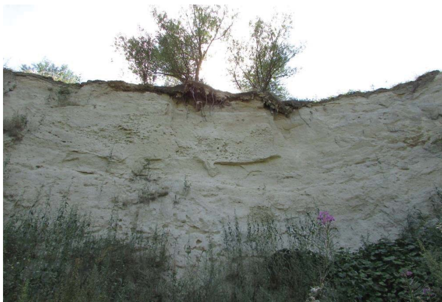
Рис. 4. Відслонення крупних фракцій хвостів флотації у північній частині хвостосховища №1
