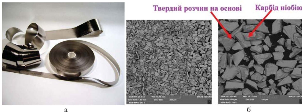
Рис. 1. Зовнішній вигляд отриманої стрічки: а – у вихідному стані; б – після розмелювання.
