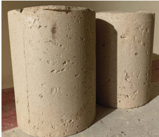
Рис. 2. Зовнішній вигляд циліндра блока гравійного обсипання
