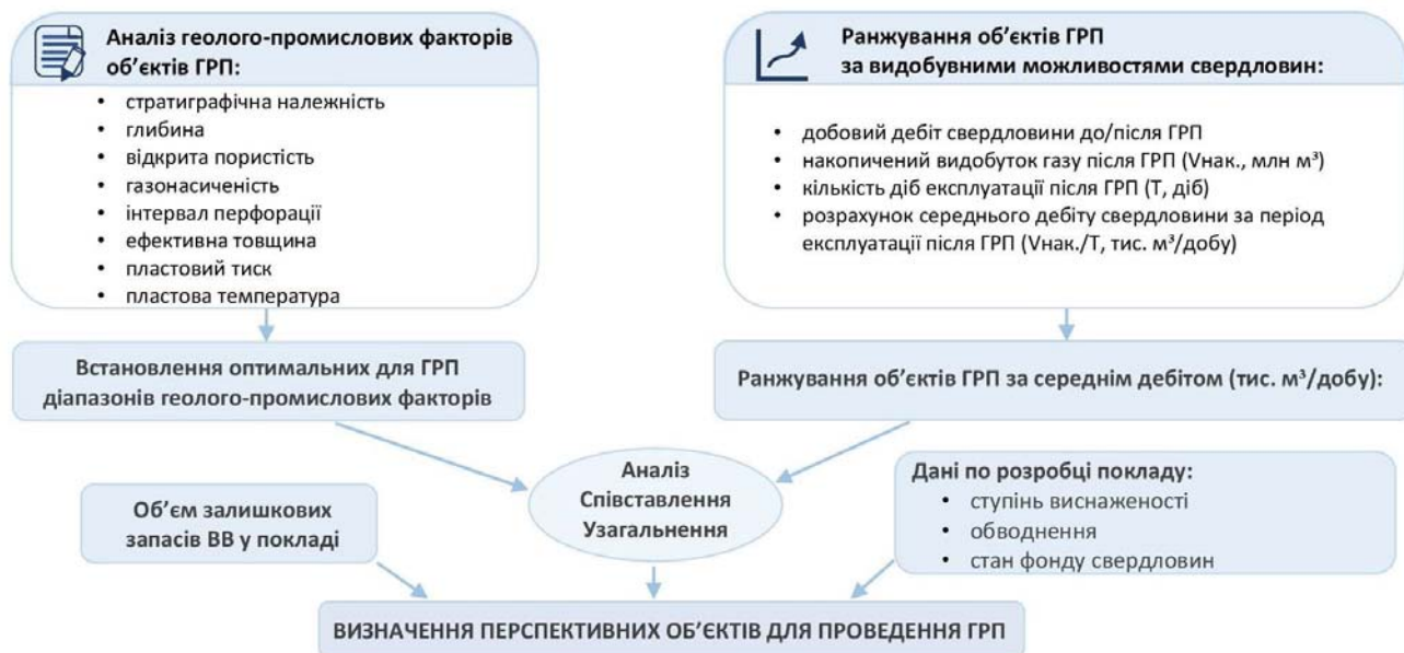
Рис. 1. Алгоритм встановлення оптимальних діапазонів геолого-промислових факторів та визначення перспективних об'єктів ГРП
