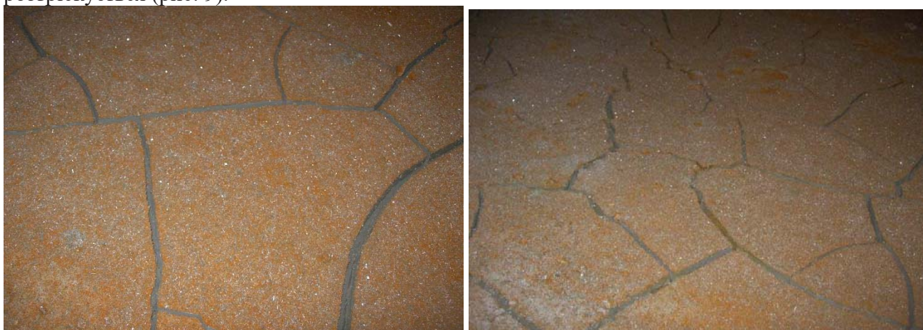
Рис. 9. Відклади глини у донній частині луговні №10, які розтріскались внаслідок зневоднення осадку
