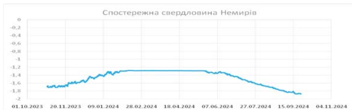
Рис. 2. Графік рівня підземних вод свердловини, облаштованої DCX-22
